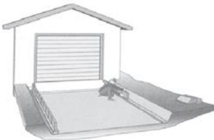
La zone excavée, où seront posées les dalles, sera clairement alignée et délimitée. L'opération peut se faire avec des bordures solidement fixées en pierre bleue ou en béton. Vous pouvez également opter pour des plinthes en acier, bois ou matière synthétique.
